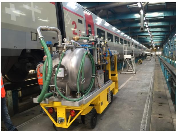
L'Unité Mobile de Vidange peut être monté sur remorque tractée par un engin motorisé, ou sur un autoporteur qui fournira alors l'énergie pour la vidange des WC.
